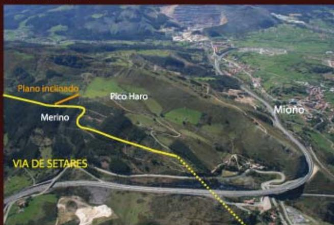
En la parte superior izquierda de la foto se representa en color naranja el plano inclinado de Merino que conectaba las explotaciones de Dícido y Setares. En la parte inferior, en línea discontinua, se representa el plano inclinado que descendía el mineral hasta el cargadero de Saltacaballos.
